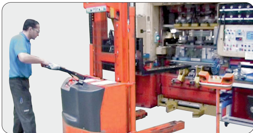
Werkzeugwechsel bei mechanischer Presse von 120 Tonnen, ausgerüstet mit einer Rotobloc-PSPC Hydraulik-Spannvorrichtung für Werkzeuge
