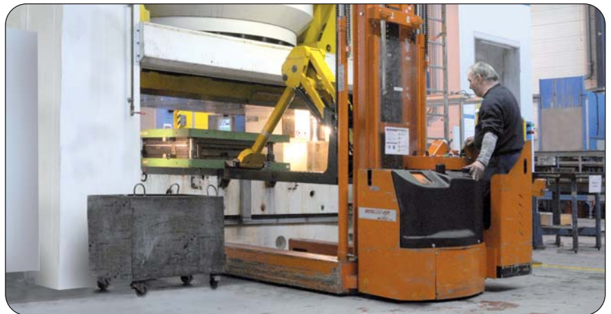
Werkzeugwechsel an einer hydraulischen Presse von 6000 Tonnen ausgerüstet mit einer magnetischen Spannvorrichtung für Werkzeuge Rotobloc-PSP
