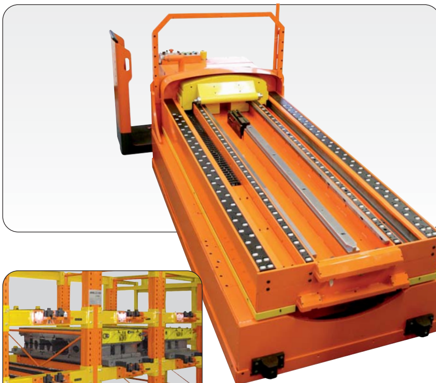
Tisch für 2 Werkzeuge mit versenkbaren Rollen
