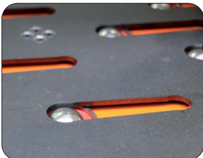
Aktivierte Kugeln ermöglichen es, das Werkzeug leicht zu manövrieren
