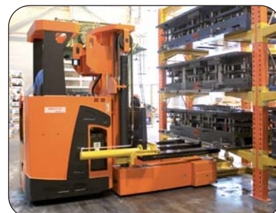
Handhabung eines Werkzeuges ohne manuellen Zugriff
