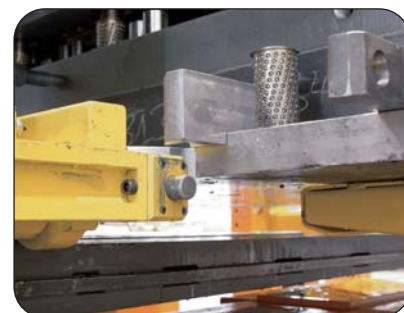
Bajonetten-Aufhängungssystem. Aufhängung des Werkzeugs in maskierter Zeit im Lagerregal.
