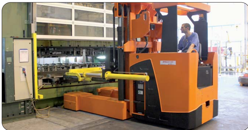
Laden eines Werkzeuges auf einer 1000-Tonnen Presse
